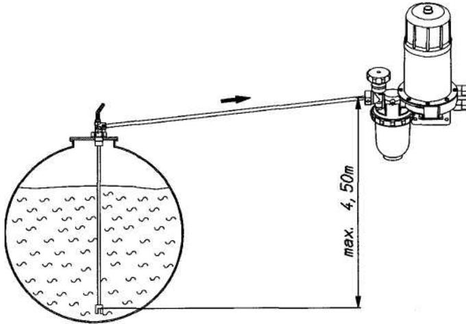
Установка FloCo-Top ниже уровня ёмкости. Чтобы предотвратить утечку мазута при повреждениях всасывающего трубопровода и в области выше уровня мазута в ёмкости, рекомендуется установить мембранный обратный клапан.
