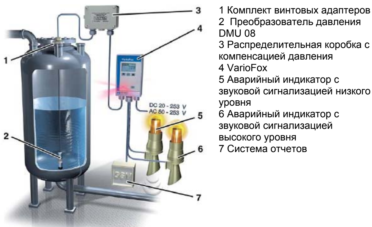
Рис. 27: Пример применения с преобразователем давления DMU 08
