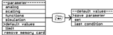
Рис. 23 Значения по умолчанию: Сохранение фактических настроек, загрузка заводских настроек (Reset)(Сброс) и восстановление сохраненных данных.
