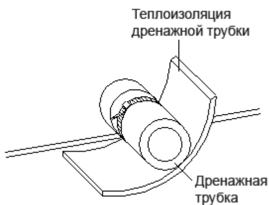
Рис.10: Теплоизоляция дренажной трубки
