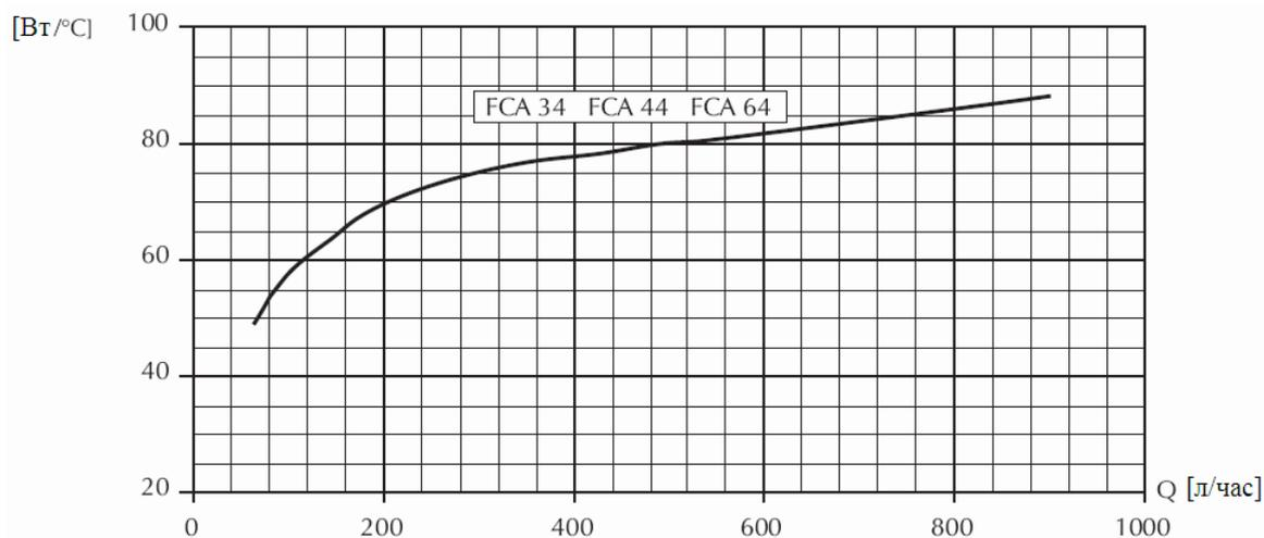
\* Чтобы получить полную теплопроизводительность, нужно умножить удельную теплопроизводительность на разность температур воды и воздуха на входе в систему.
