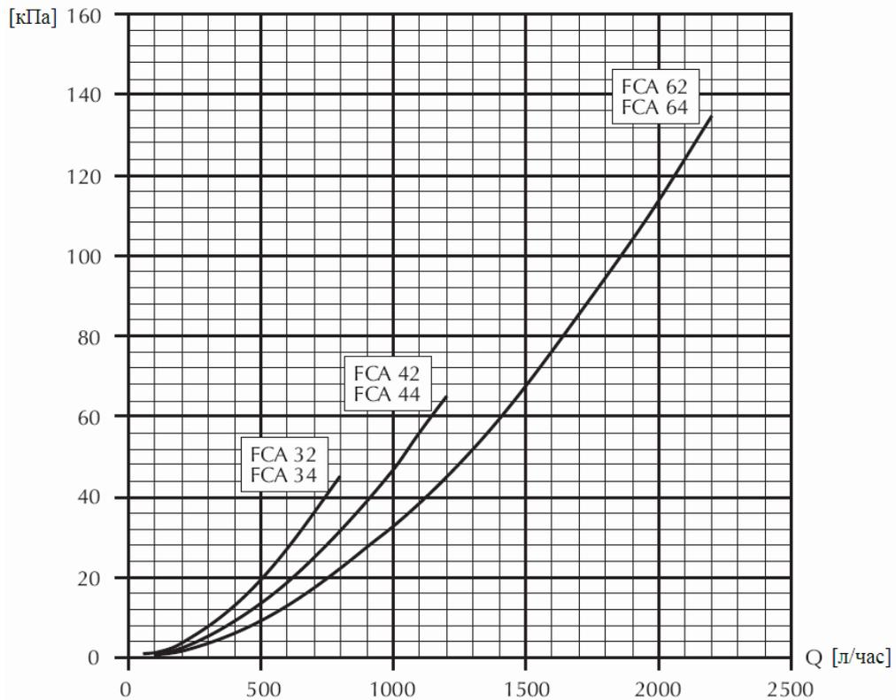
Приведенные на графиках значения падения давления соответствуют средней температуре воды 10°C. В приведенной ниже таблице указаны поправочные коэффициенты, на которые следует умножить эти значения при других средних температурах воды.
