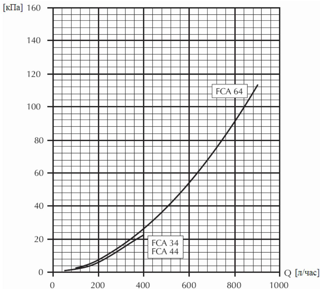
Приведенные на графиках значения падения давления соответствуют средней температуре воды 65°C. В приведенной ниже таблице указаны поправочные коэффициенты, на которые следует умножить эти значения при других средних температурах воды.
