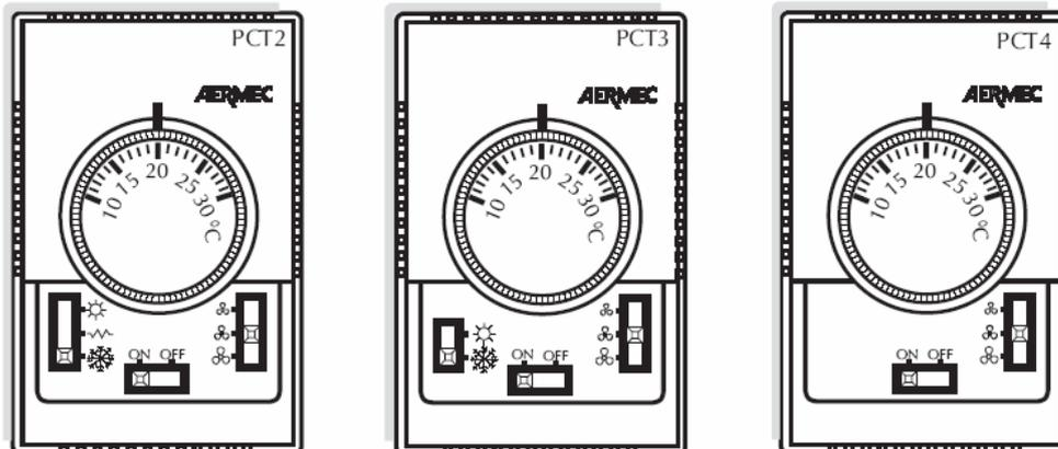
**ПАНЕЛЬ УПРАВЛЕНИЯ С ПЕРЕКЛЮЧАТЕЛЕМ СКОРОСТИ ВЕНТИЛЯТОРА**
