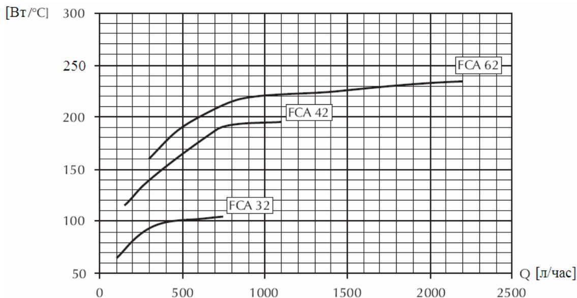
\* Чтобы получить полную теплопроизводительность, нужно умножить удельную теплопроизводительность на разность температур воды и воздуха на входе в систему.
