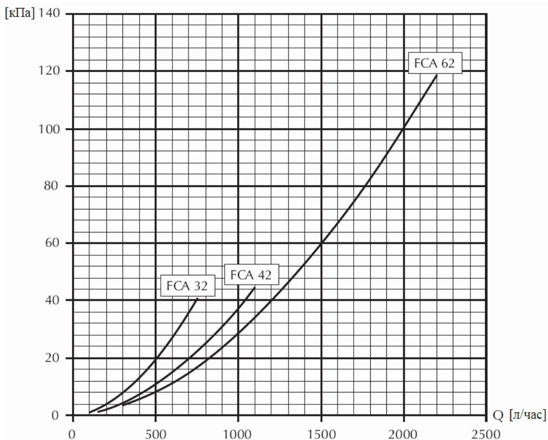
Приведенные на графиках значения падения давления соответствуют средней температуре воды 65°C. В приведенной ниже таблице указаны поправочные коэффициенты, на которые следует умножить эти значения при других средних температурах воды.
