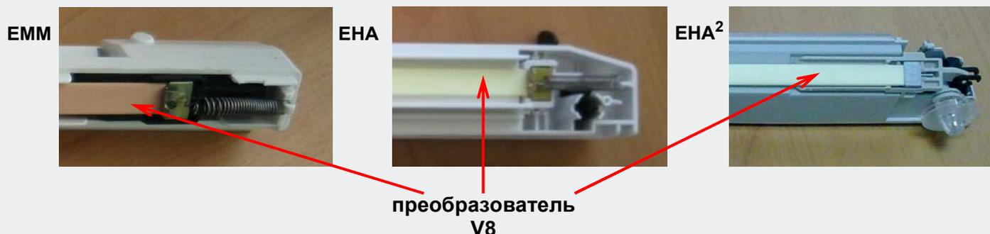
Преобразователь V8 находится изолировано от направления воздушного потока и измеряет только уровень влажности в помещении. К тому же, благодаря системе тепловой корректировки, процесс открытия заслонки происходит независимо от внешних климатических условий.
