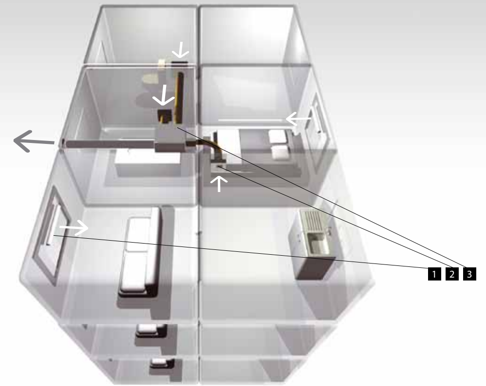
1. Приточные устройства. 2. Вытяжные устройства. 3. Вентилятор
