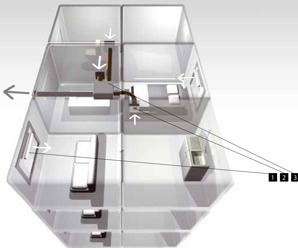
1. Приточные устройства. 2. Вытяжные устройства. 3. Вентилятор
