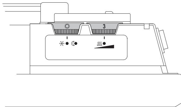
После нагрева воздуха в помещении до заданной температуры прибор поддерживает ее на постоянном уровне, периодически включая режим нагрева (при этом мощность используемого прибора должна быть не ниже необходимой для обогрева данного помещения).
