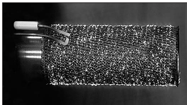
Рис. 14: Горелочная труба с покрытием NIT в действии
