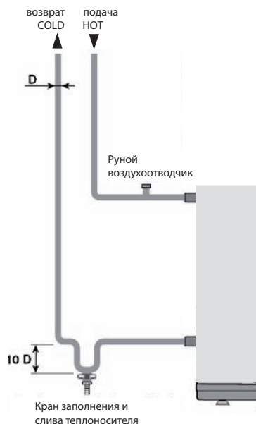
Рис. 8. Рекомендованные элементы на трубопроводах подключения тепло-аккумулятора
