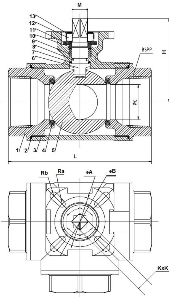
**Габаритные размеры, вес и Kv (таблица) кранов шаровых нержавеющей из стали AISI316 (CF8M) DN 8-50 PN 40 резьба/резьба.
