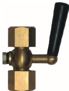
Правила устройства и безопасной эксплуатации сосудов, работающих под давлением, в частности, требуют: "Перед каждым манометром должен быть установлен трехходовой кран или другое аналогичное устройство для продувки, проверки и отключения манометра". Если при соединении с атмосферой стрелка падает до нуля, то вероятность отказа манометра (залипания стрелки) считается минимальной.
