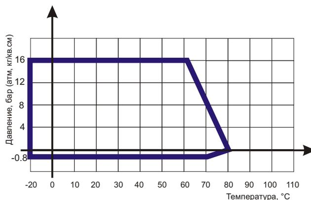
Диаграмма определяет рабочую область для вставок гибких фланцевых и резьбовых - антивибрационных компенсаторов в координатах Давление (в барах приборного) / Температура (° C).
