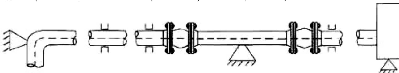
4. Гибкие вставки следует устанавливать непосредственно за неподвижной опорой. За гибкой вставкой следует предусмотреть подвижные опоры
