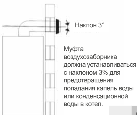
Рисунок 9. Наклон конденсора
