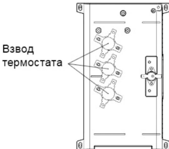
Рис. 18. Ручное восстановление термостатов
