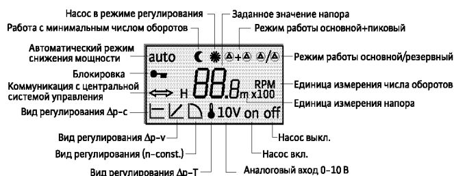
Рис.: Символы на дисплее насоса
