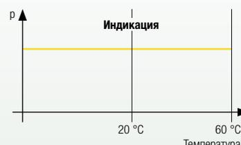
Отображаемое значение давления после температурной компенсации
