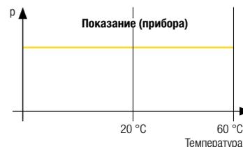
Показание давления при компенсации температурного воздействия
