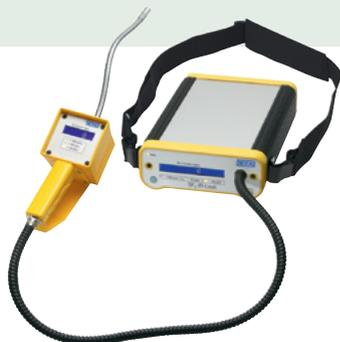
Инфракрасный течеискатель (IR-Leak) с диапазоном измерения в 2000 ppm<sub>v</sub> является идеальным измерительным прибором для обнаружения утечек и их количественного определения.
