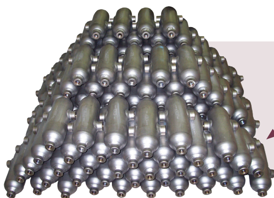
Конденсационные и уравнивательные сосуды используются в качестве буфера между главной технологической линией и вторичными приборами при измерении расхода и давления жидкостей, пара или испарений, которые могут влиять на вторичные измерительные приборы.
