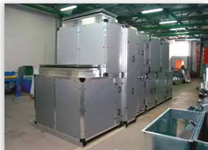
Центральный кондиционер с роторным регенератором
