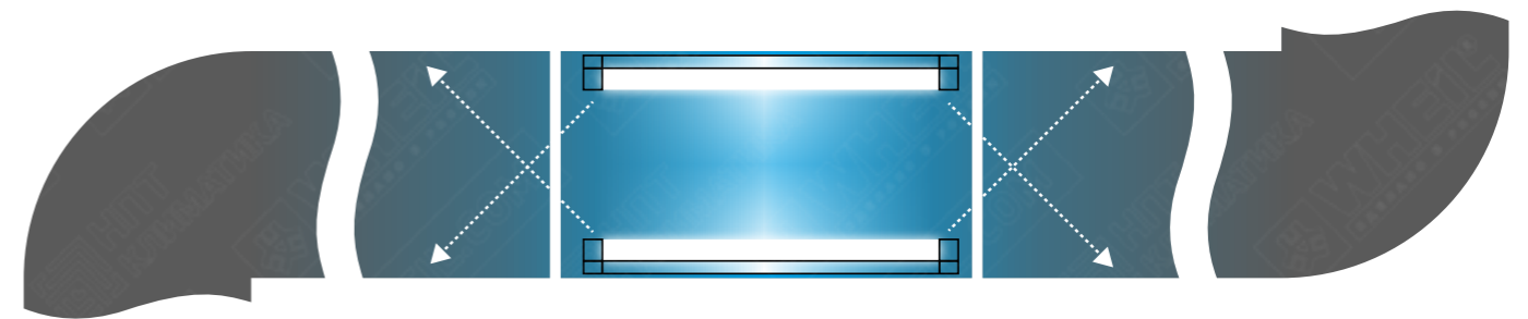
Ограничение области обеззараживания длиной лампы
