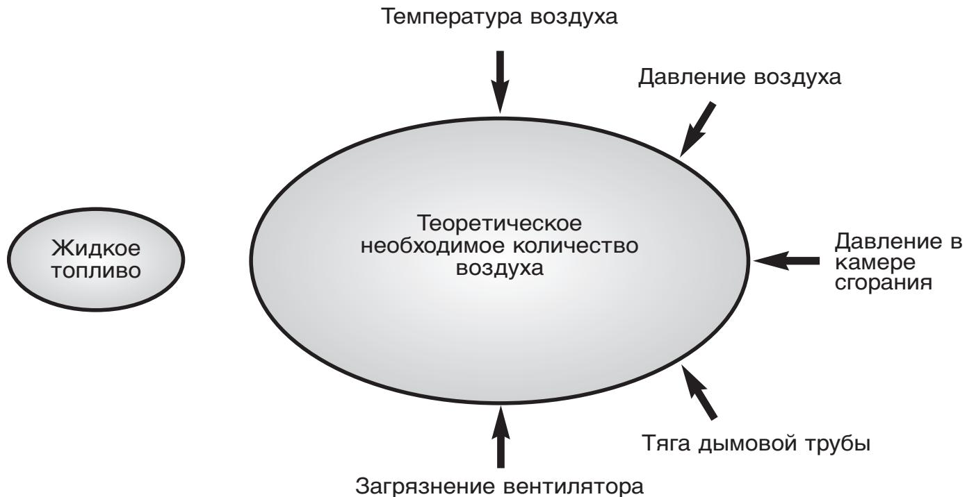
Теоретический объем воздуха, необходимый для качественного полного сгорания определенного количества жидкого топлива, может быть рассчитан.
