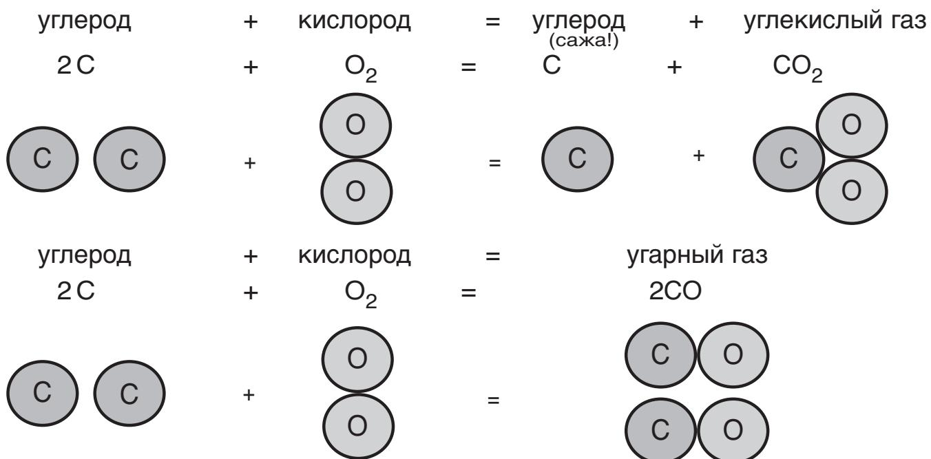
Даже если при горении топлива воздуха слишком мало, водород и сера сгорают полностью. Вследствие этого остается недостаточно кислорода для горения углерода. Поэтому после сгорания остается избыток углерода
