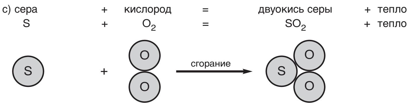
Сгорание жидкого топлива при смешивании с воздухом означает, что горючие составляющие жидкого топлива реагируют с кислородом воздуха.
