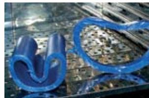
Рис. 44. Испытание памяти Compact Pipe (испытание на этапе «П»)
