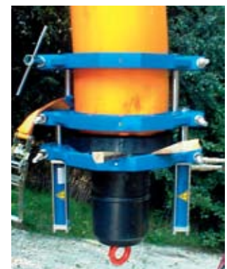
Рис. 20. Металлический наконечник для протягивания (слева) и полиэтиленовая заглушка, приваренная встык к торцу трубы.
