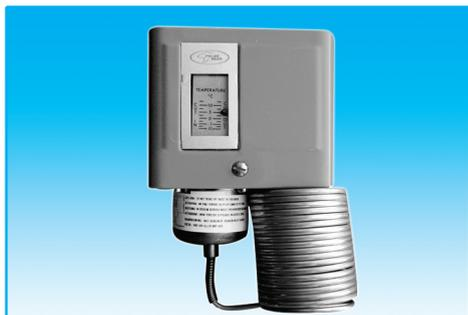
Термостаты PBFP предназначены для защиты от замораживания водяных нагревателей систем вентиляции или кондиционирования воздуха. Калорифер может быть защищен по температуре воздуха за калорифером. Чувствительным элементом датчика является капилляр, помещаемый в рабочую область калорифера. Температура срабатывания устанавливается с помощью настроечного винта. При необходимости настроечный винт термостата может быть опломбирован.
