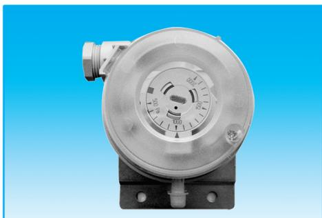
Реле давления предназначено для контроля падения давления на элементах систем вентиляции и кондиционирования, например, степени загрязнения фильтра, напора вентилятора и т. д. На корпусе реле расположены два патрубка для подсоединения к точкам измерения с помощью гибких трубок. Рекомендуется устанавливать реле вертикально патрубками вниз. В горизонтальном положении шкала настройки будет иметь дополнительную погрешность.
