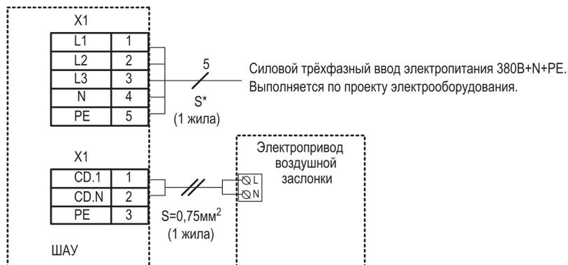
Схема внешних соединений модуля с применением электропривода воздушной заслонки с контактами сигнализации положения.
