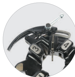
Автоматическая резьбонарезная головка
