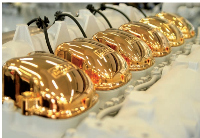
Сердце когенерационной установки: газопоршневой двигатель.
