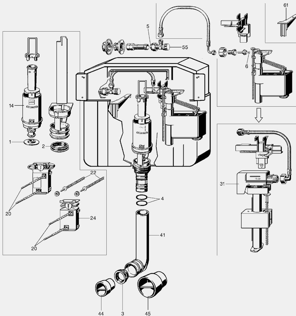
Смывной бачок Standart 1S для кнопок смыва Standard с функцией «смыв-стоп»
