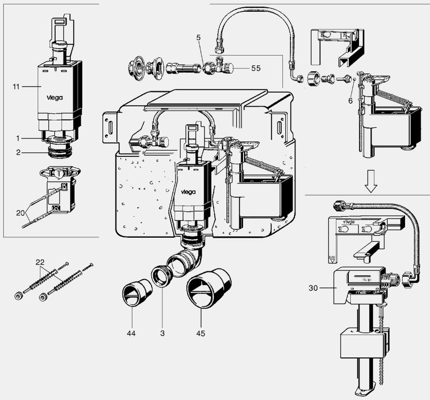
Бачок скрытого монтажа 2L для кнопок смыва Visign, малая конструктивная высота, фронтальная или верхняя установка кнопок смыва, производства с 2014 года, используется в: Steptec модели 8430.3 и 8430.18
