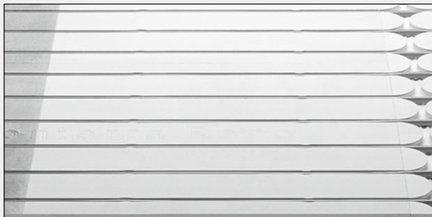
Сухая система напольного отопления с гипсоволоконной плитой 18 мм с фрезерованными направляющими для трубы для конструктивной высоты от 21 мм. Возможны различные конструкции: монтажная плита, цементная стяжка или прямая укладка плитки.
