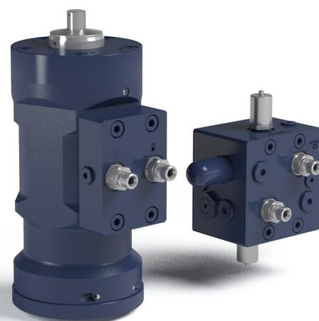
\* Гидравлический блок управления поддерживает гидравлическое давление внутри привода в случае повреждения гидравлических шлангов и может использоваться для регулировки давления каждого отдельного привода
