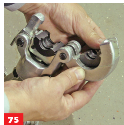
75 - затем аналогично устанавливается второй пресс-вкладыш
