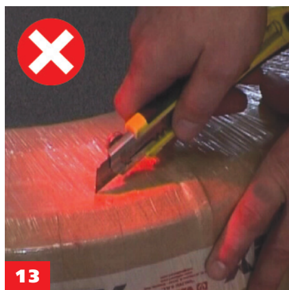
13 Во избежание повреждения трубы разрезать упаковочные ленты ножом не рекомендуется
