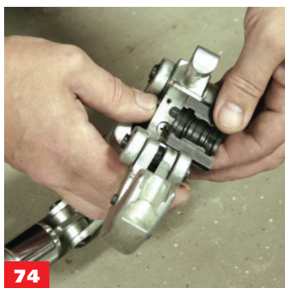
74 - при нажатой кнопке фиксатора в обойму (по направляющим сбоку) устанавливается сначала один пресс-вкладыш;
