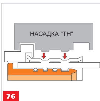
76 Пресс-вкладыши для фитингов VTm200 должны иметь профиль типа «ТН». Использование насадок другого профиля НЕ ДОПУСКАЕТСЯ!
