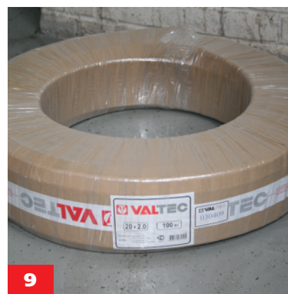
9 Если бухта металлополимерной трубы доставлена в помещение с мороза, ей дается возможность вылежаться в течение 5 часов при температуре не менее 10° С
