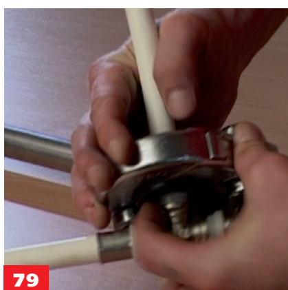
79 После фиксации инструмента обойма закрывается до защелкивания замка
