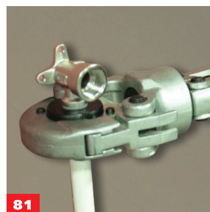
81 Смыканием рукояток производится опрессовка гильзы
