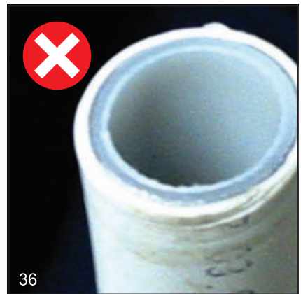
Если труба одета на комбинированный калибратор не до конца, то снятия фаски либо не происходит, либо производится некачественно
