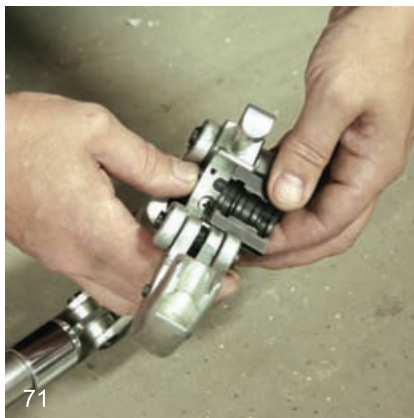
71 – при нажатой кнопке фиксатора в обойму (по направляющим сбоку) вставляется сначала один пресс-вкладыш;
