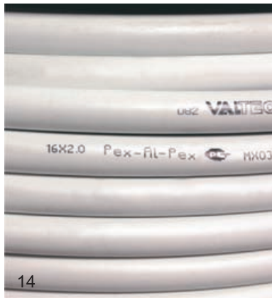
14 Проверяется соответствие указанных на трубе максимально допустимых температуры и давления реальным условиям эксплуатации
