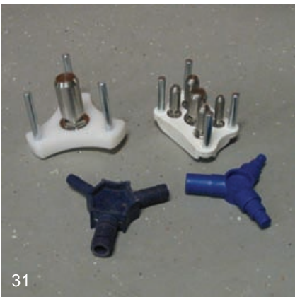
Для придания поперечному сечению трубы строго круглой формы она калибруется с помощью обычного или комбинированного калибратора:
