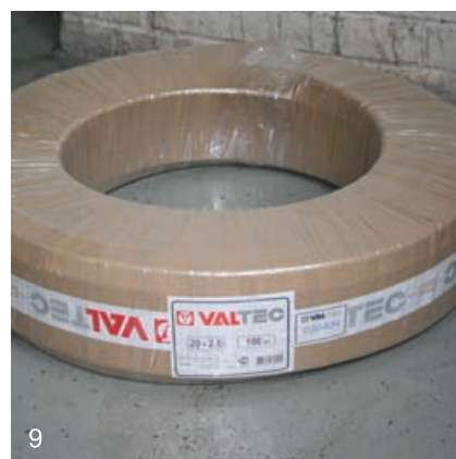
9 Если бухта металлополимерной трубы доставлена в помещение с мороза, ей дается возможность вылежаться в течение 5 часов при температуре не менее 10°C
