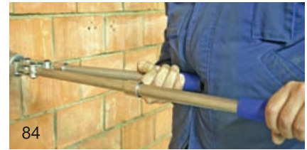
84 Для снижения прикладываемых усилий, можно увеличить длину рукояток, для чего одну часть телескопической рукоятки следует повернуть относительно другой. Поскольку в сечении обе детали рукоятки имеют небольшую овальность, это даст возможность их взаимного перемещения. Таким же поворотом друг относительно друга достигается фиксация деталей рукоятки при достижении требуемой длины
