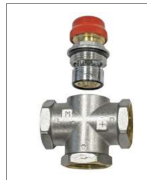
VT.MR 01 клапан с боковым смешением для установки на байпасе. Полное перекрытие байпаса невозможно, что позволяет избежать установки перепускного клапана. Повышенная пропускная способность
