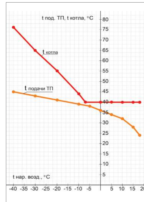
Рис. 26. Погодозависимые графики котла и насосно-смесительного узла.
