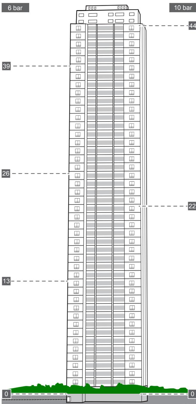
Система напольного отопления Uponor 10 бар позволяет смонтировать в многоэтажных зданиях напольное отопление (UFH) с рабочим давлением до 10 бар вместо стандартных 6 бар. Это позволяет снизить затраты на планирование и проектирование, поскольку становятся не нужны обычно применяемые компоненты для снижения давления и улучшения теплопередачи.
