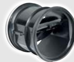
**Зубчатая кромка для снижения уровня шума воздушного потока.** Проверенный временем регулятор постоянного расхода TROX был усовершенствован и акустически оптимизирован при помощи новой зубчатой кромки заслонки клапана. Новый стикер на регуляторе содержит информацию о значениях уставки в л/с, м<sup>3</sup>/ч и кубических футах в минуту. Ограничитель расхода VFL может быть использован везде, где требуется поддержка постоянного объема расхода воздуха.
