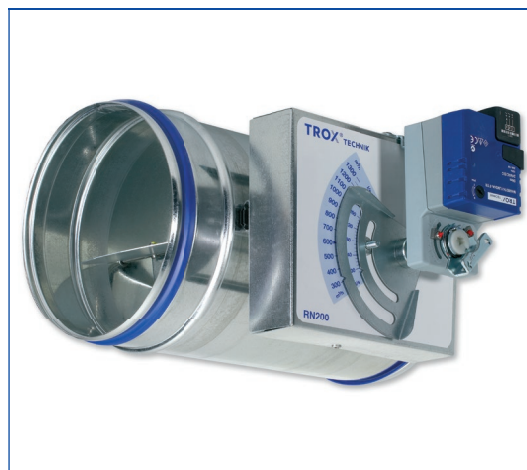
CAV-регулятор Серии RN, с сервоприводом для переключения между требуемыми значениями расхода воздуха
