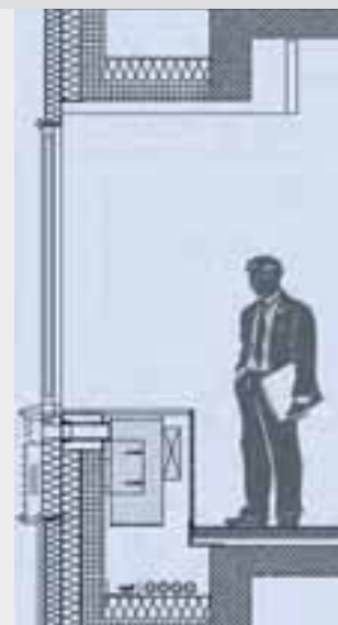
Ненесущая наружная стена со встроенными системами инженерных коммуникаций Здание Lighttower, Франкфурт-на-Майне (Германия)
