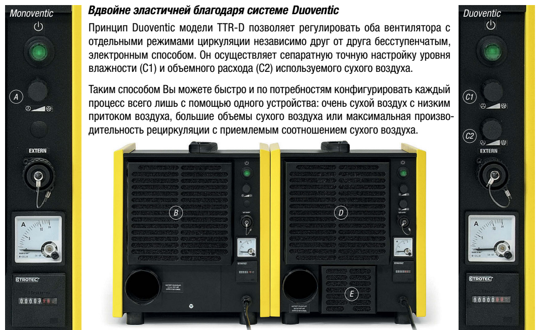
Отличие моделей при прямом сравнении: На левой стороне находится TTR 400 с функцией регулирования объема воздуха (A) и комбинированным входом для двух потоков воздуха (B), справа TTR 400 D с управлением Duoventic (C1, C2) и сепаратным впуском для сухого воздуха (D) и регенерационным воздухом (E).
