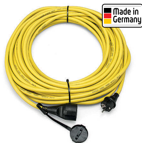
Удлинительный кабель 230 В, 16 А, H07RN-F 3G2,5
