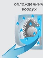
Благодаря самоочистке во внутреннем блоке никогда не образуется сырость, плесень, неприятный запах. После выключения кондиционера вентилятор работает ещё 30 минут, осушая теплообменник, а затем выключается автоматически.
