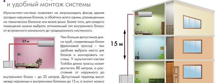
Чем больше допустимая длина труб, соединяющих блоки (фреоновая трасса) – тем удобнее выбрать место для блоков и монтировать систему. У мультисплит-систем Toshiba длина трассы может достигать 80 метров, а расстояние от наружного до внутреннего блока – до 25 метров. Допустимый перепад высот между наружным и внутренними блоками до 15 м, а значит можно кондиционировать даже трехэтажный дом одной системой!
