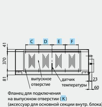
Фланец для подключения на выпускном отверстии (K) (аксессуар для основной секции внутр. блока)
