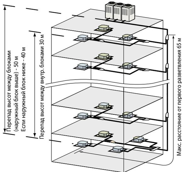
Увеличена допустимая длина межблочных трубопроводов, подключаемых к Toshiba Super MMS, что предоставляет дополнительные возможности при монтаже системы.
