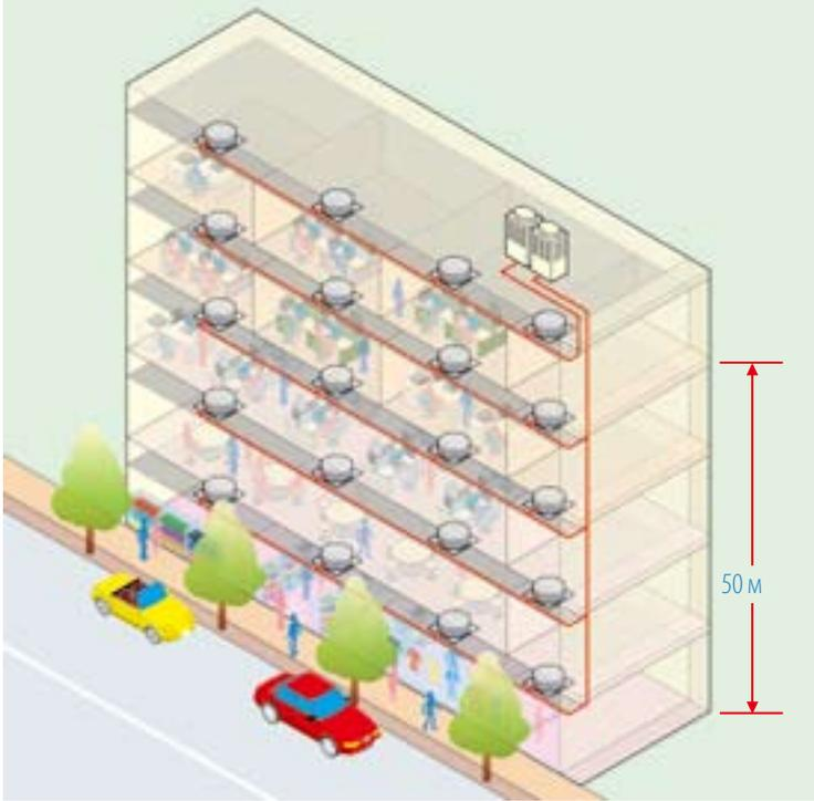
В единую мультизональную систему могут быть объединены до 48 внутренних блоков суммарной мощностью до 135% от производительности внешних блоков.
