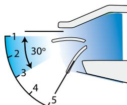
В режиме обогрева жалюзи автоматически покачиваются между пятью положениями.
