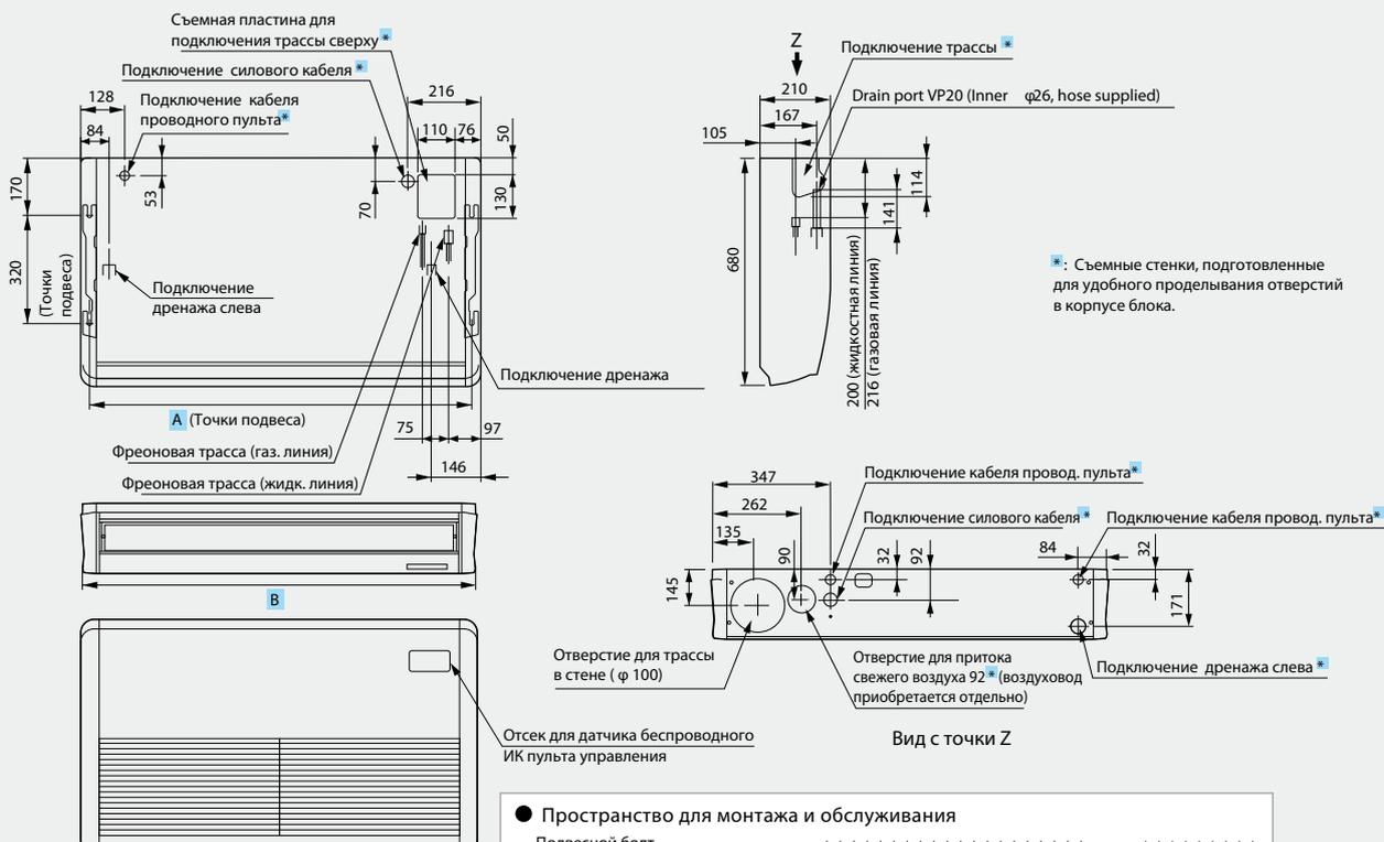
\*: Съемные стенки, подготовленные для удобного проделывания отверстий в корпусе блока.
