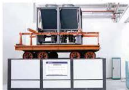
Платформа для симуляции транспортировки оборудования
