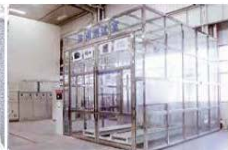
Лаборатория, симулирующая эксплуатацию оборудования в условиях дождей и ливней
