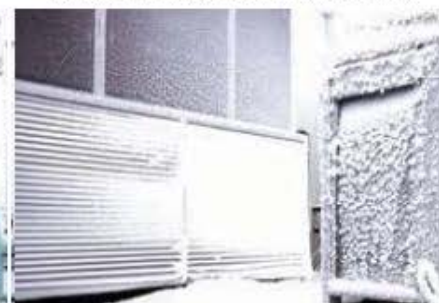
Лаборатория, симулирующая эксплуатацию оборудования в заснеженных условиях. Диапазон температур составляет от -40 до +55 °C
