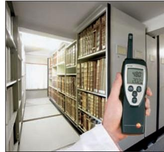
Компактный прибор **testo 625** с наконечником зонда влажности и температуры в комплекте. Большой двухстрочный дисплей отображает значения влажности, температуры шарика смоченного термометра или точки росы, также как и температуры.
