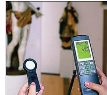
Люксметр **testo 540** с функцией соотношения данных к месту замера и расчетом среднего значения.
