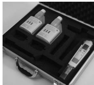
Портативный pH/°C измерительный инструмент, pH2 наконечник зонда для полутвердых продуктов, колпачок для хранения с гелем, дозирующие флаконы с буферными растворами для калибровки 250 мл pH 4+7, чехол TopSafe, держатель ремня/стены в алюминиевом кейсе
