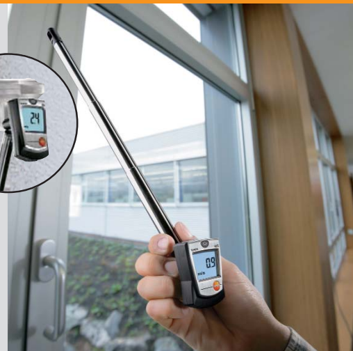
Измерение скорости потока воздуха у негерметично закрытых окон
