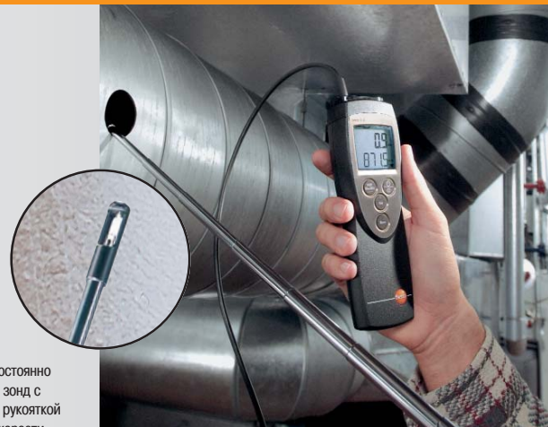
testo 425, используется например для мониторинга объемного расхода отработанного воздуха
