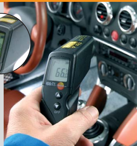
Проверка температуры у вентилятора
