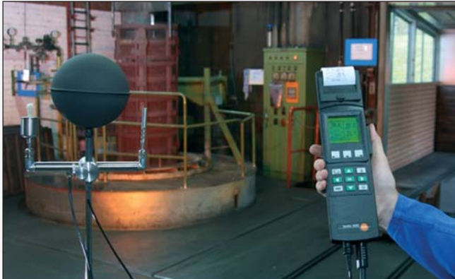
Измерение прибором testo 400 и сферическим зондом температуры
