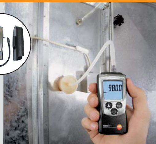
Измерение абсолютного давления, напр. для компенсации абсолютного давления при измерении скорости потока трубкой Пито
