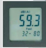
Частотная оценка текущего значения Временная оценка Установка диапазона измерения
