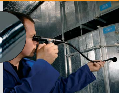
Инспекция воздуховода с подсоединенной гибкой трубкой для обеспечения средней гибкости зонда
