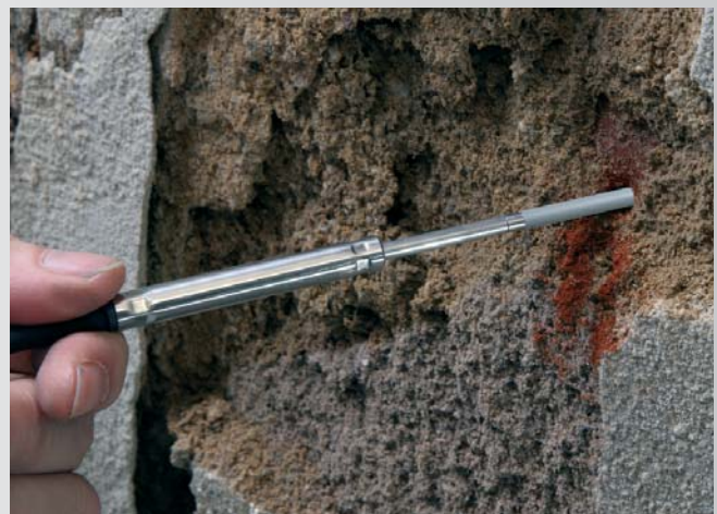
Поместить зонд влажности в тефлоновом защитном колпачке в растачиваемое отверстие
