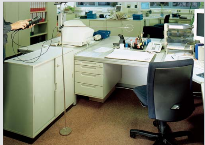
Прибор testo 400 с подключенным зондом для измерения уровня турбулентности
