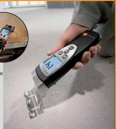
Быстро и легко – проверка влажности маяка. Проведение измерений в нескольких точках измеряемой поверхности обеспечит более надежные результаты.
