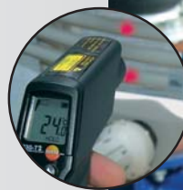
2-х точечный лазерный целеуказатель (реальная точка замера)
