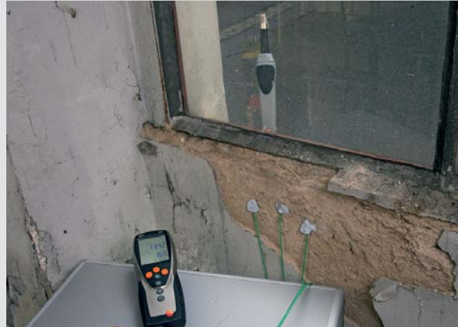
Измеряет коэффициент теплопередачи U в стене на предмет проведения ремонта, используя U-зонд и беспроводной зонд температуры/влажности (альтернативно возможно использование стандартного зонда температуры)
