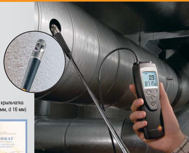
Мониторинг объемного расхода в воздуховодах
