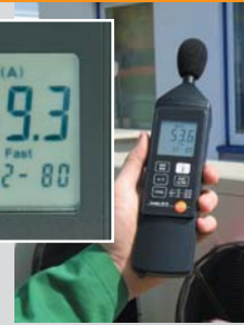
testo 815, мониторинг уровня шума в системах вентиляции
