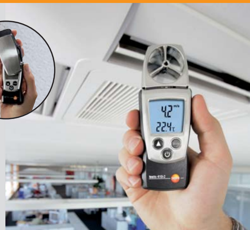
Измерение скорости потока на выходе воздуховода крыльчаткой D 40 мм
