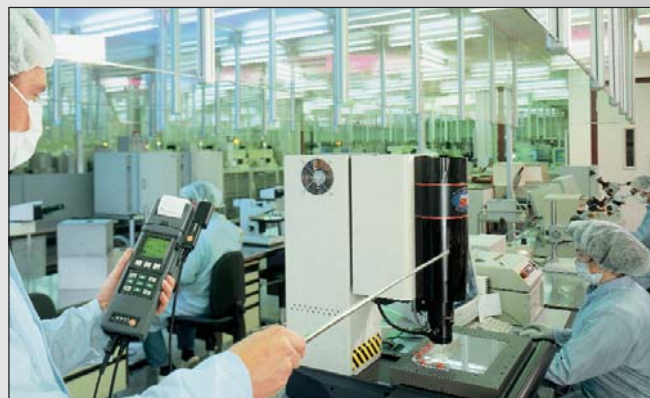
Проверка скорости потока воздуха с помощью зонда с обогреваемой струной (№ заказа: 0635 1047)
