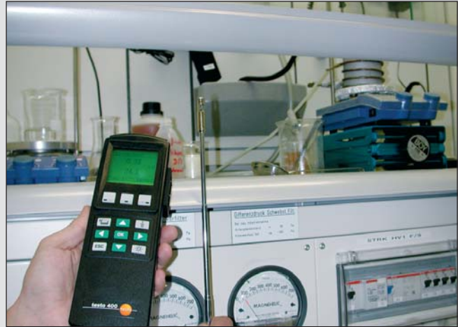
Проверка работы вытяжного шкафа на месте с прибором testo 400
