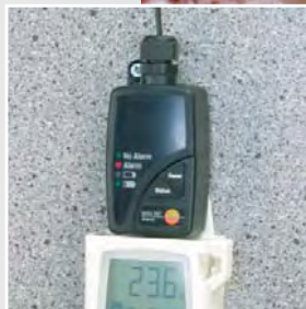
testo 581, трансмиттер сигнала тревоги для надежного предупреждения о превышении предельных значений
