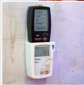
testo 580, коллектор данных, сбор данных и перенос на ПК по месту
