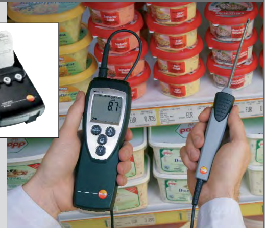
Проверка охлаждаемого прилавка для поддержания достаточного уровня охлаждения
