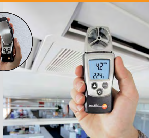
Измерение скорости потока на выходе воздуховода крыльчаткой D 40 мм
