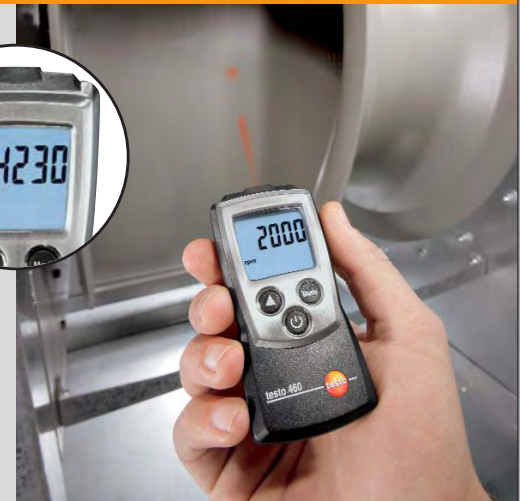
Бесконтактное измерение скорости вращения вентилятора
