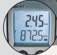
Объемный расход прямо отображается на большом четком дисплее
