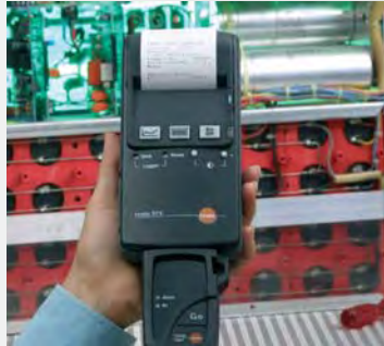
Быстрая распечатка данных и перезагрузка регистратора данных с помощью принтера testo 575
