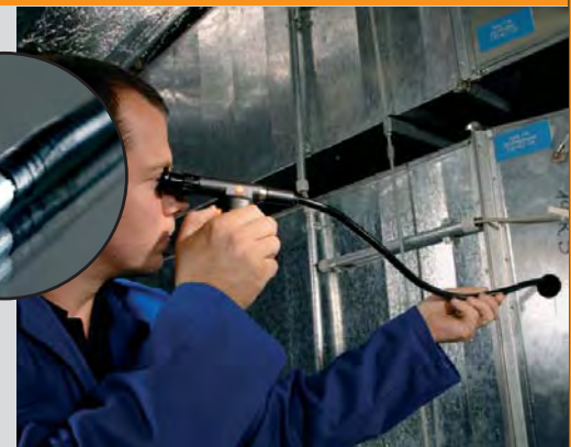
Инспекция воздуховода с гибкой насадкой средней гибкости
