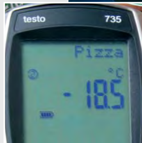
Отображение на дисплее наименования места замера и параметра. В приборе может быть сохранено до 99 описаний измерений (для testo 735-2)
