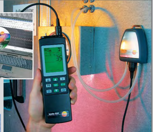
Мониторинг фильтров с помощью внешнего зонда давления 100 Па
