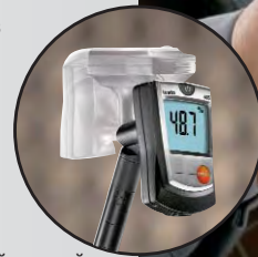
Мониторинг уровня влажности, напр. в воздуховоде системы вентиляции
