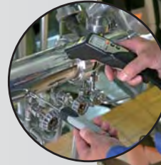
Измерение температуры внешнем зондом
