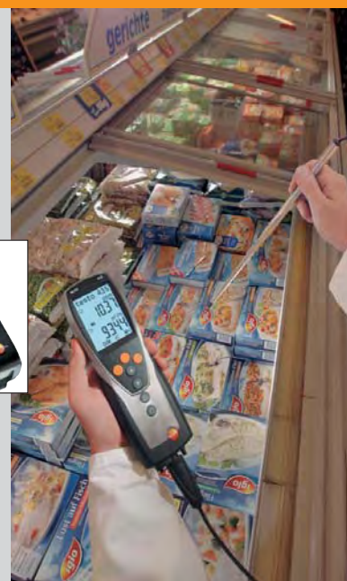
Мониторинг циркуляции воздуха в холодильных витринах
