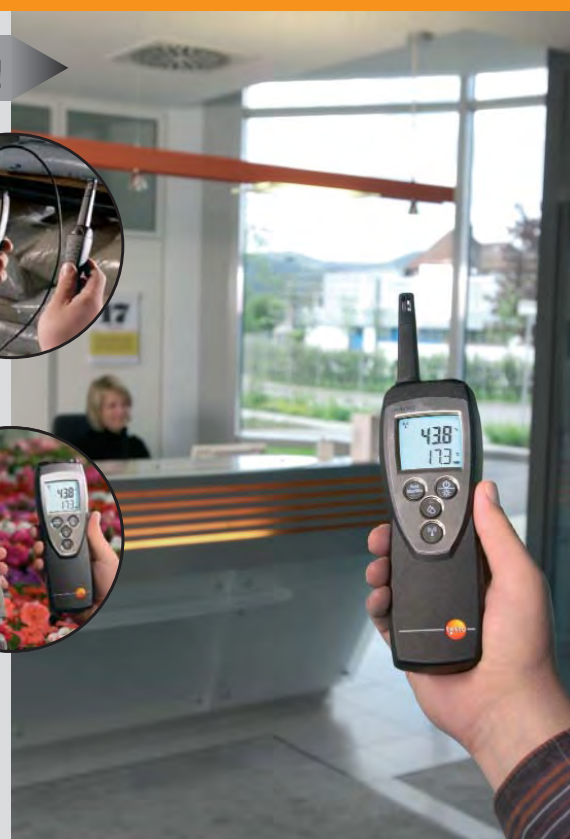
Мониторинг условий окружающей среды в помещении с подсоединенным зондом влажности
