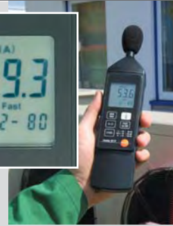
testo 815, мониторинг уровня шума в системах вентиляции
