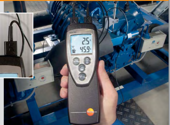
Мониторинг дифференциальной температуры компрессора с помощью обхватывающих трубу зондов
