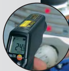
2-х точечный лазерный целеуказатель (реальная точка замера)
