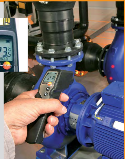
Бесконтактное измерение температуры трубы прибором testo 830-T1.
