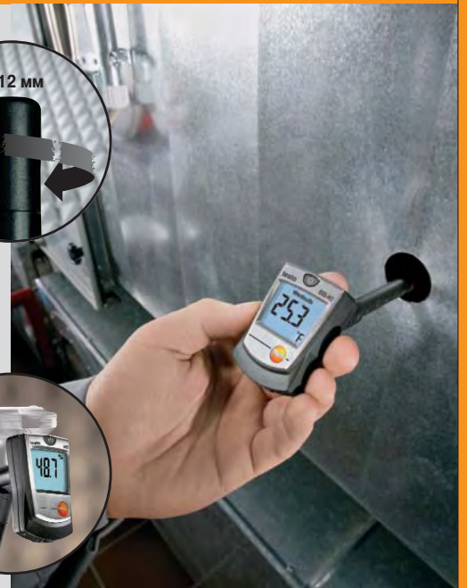
Мониторинг уровня влажности, напр. в воздуховоде системы вентиляции
