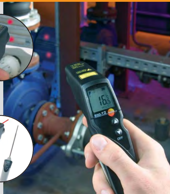
Проверки, напр. температуры компрессора
