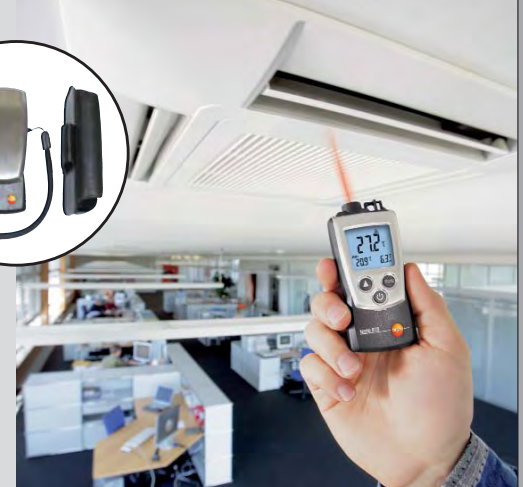
Автоматическое отображение дифференциальной температуры
