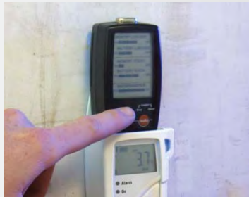
Коллектор данных testo 580 сохраняет данные на месте замера для загрузки в ПК/ноутбук для анализа
