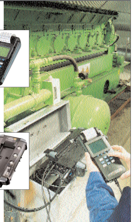
Простое и удобное измерение выбросов двигателей позволяет производить их настройку по месту
