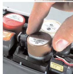
Измерительные ячейки могут быть быстро и просто заменены пользователем непосредственно на месте проведения замеров
