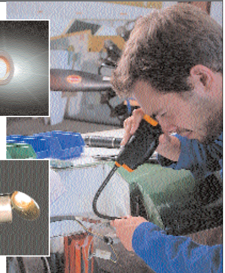
Точная проверка сварных швов, напр., в полостях
