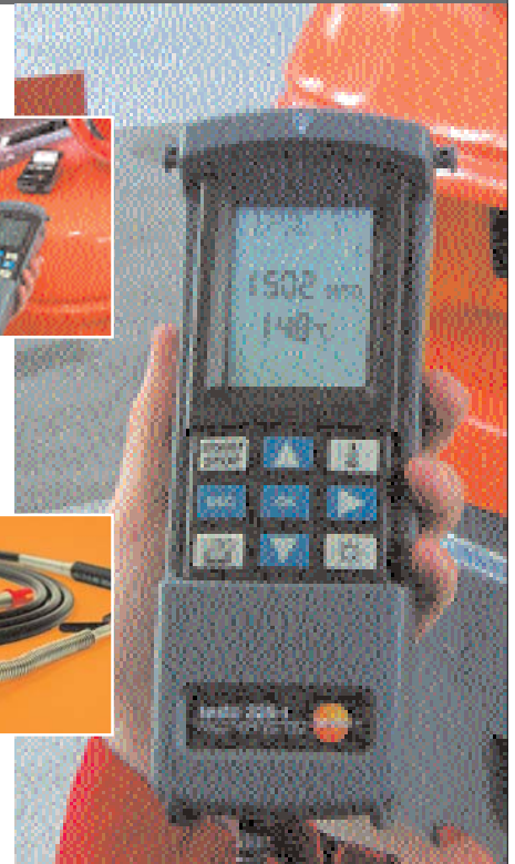
Настройка двигателей с помощью анализатора CO выс [O 2 ]
