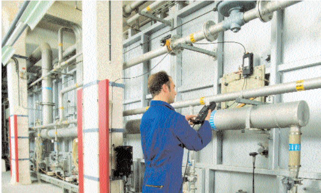
testo 350 M: Комплект для быстрого измерения параметров выбросов промышленных горелок (O 2 , CO, NO, SO 2 )
