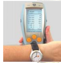
Функция регистрации данных - на протяжении периода до 2 часов
