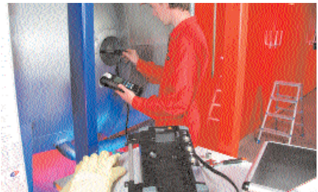
testo 350 XL: Контрольные измерения на турбинах (O 2 , CO низ , NO низ , NO 2 )
