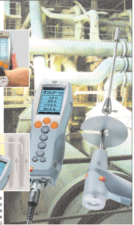
Измерения в запыленных газах с использованием фильтров предварительной очистки
