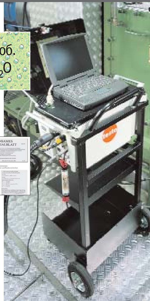
testo 360 может применяться в качестве стационарного измерительного устройства, например, при пробных пусках двигателей
