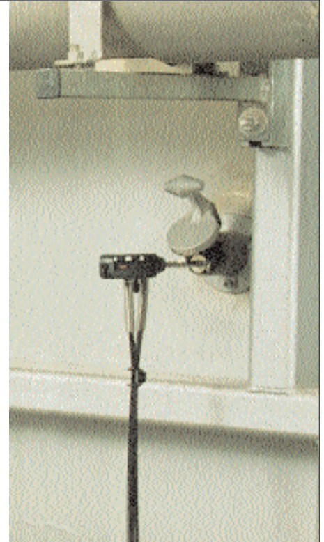
Стандартные газоотборные зонды выпускаются длиной от 335 до 700 мм.
