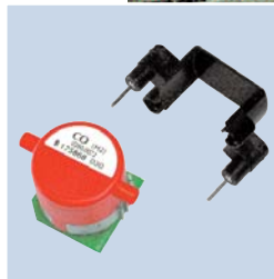
Элемент обогрева измерительной ячейки защищает от появления конденсата и повышает чувствительность сенсора при низких температурах окружающей среды
