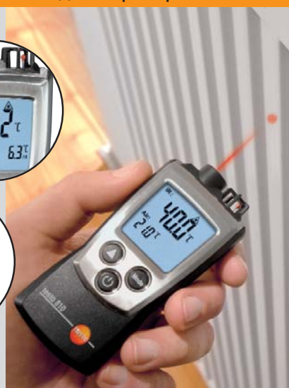
Проверка температуры поверхности радиатора одновременно с измерением температуры окружающей среды
