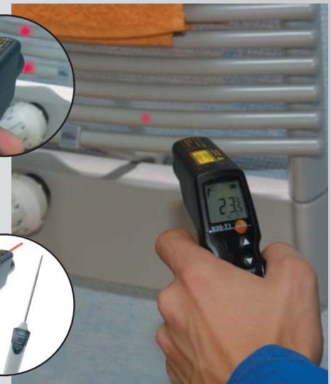
Проверка температуры в отопительных системах
