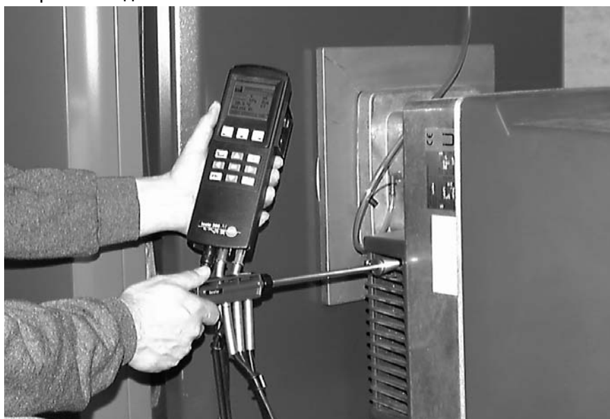
Рис. 12: Измерение температуры воздуха подающегося на горение
