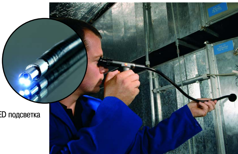
Рис 22. Инспекция теплоизоляции с помощью эндоскопа testo 319
