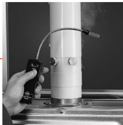
Тест утечки дымовых газов с использованием прибора testo 317
