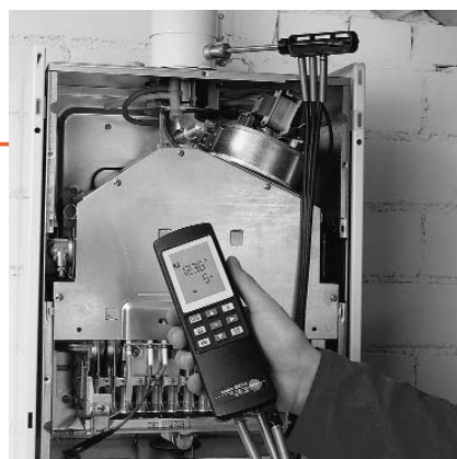
Тест дымовых газов с использованием приборов testo 327, 330-1LL, 330-2LL
