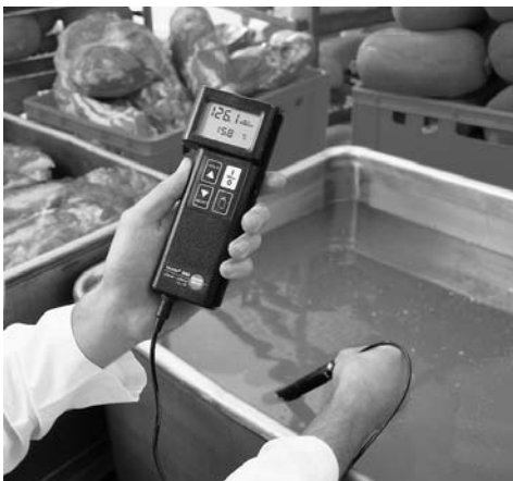
Рис. 31: Измерение электропроводности в рассоле при производстве ветчины
