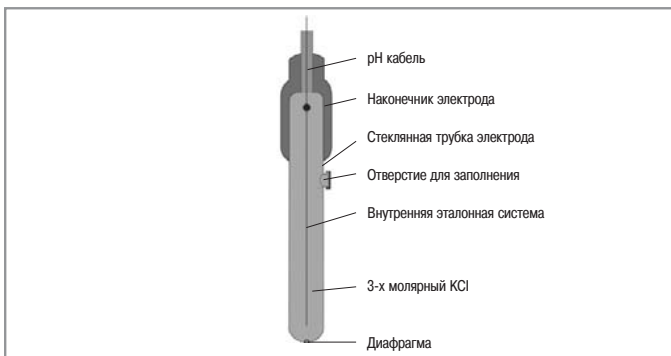
Рис. 8: Конструкция электрода сравнения
