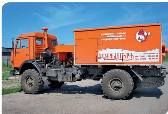
Теплогенератор «Горыныч» на шасси «Камаз»
