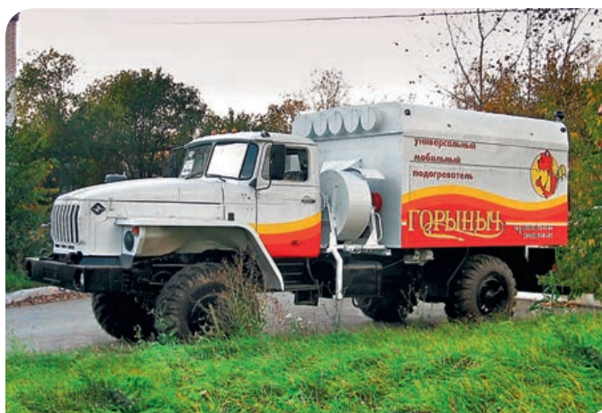
Теплогенератор «Горыныч» на шасси «Урал»
