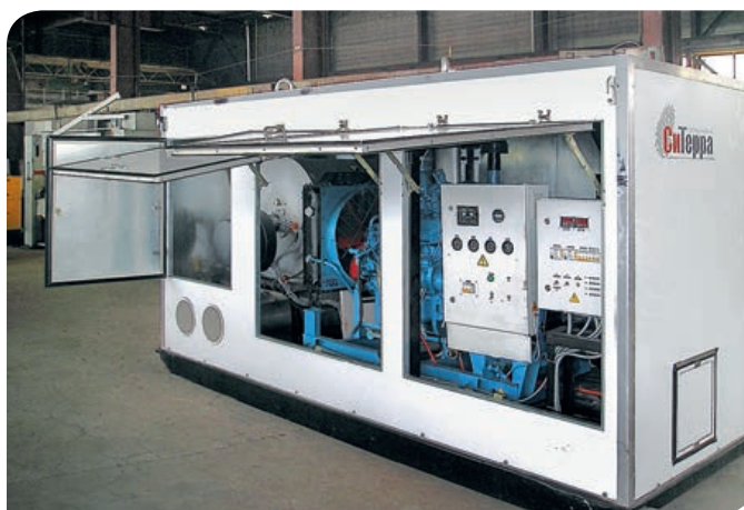
Теплогенератор «Тайга» на санях. Использование в условиях крайнего севера, либо по зимнему бездорожью в центральной части России
