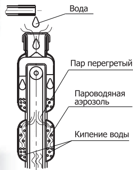
Принцип работы блока парогенератора:
